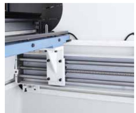
Präzise Positionierung des Hinteranschlags durch Kugelumlaufspindeln
