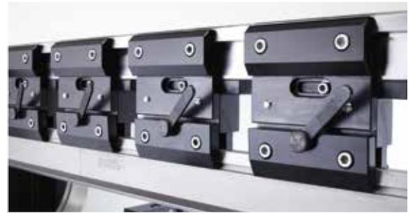
Oberwerkzeughalterung mit Schnellwechselsystem
