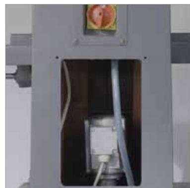
Kühlmittelpumpenmotor 90 W,
