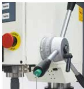
VBM SG: Dreifach-Bedienhebel mit Schaltelementen für Drehrichtungsumkehr (Gewindeschneidmodus)
