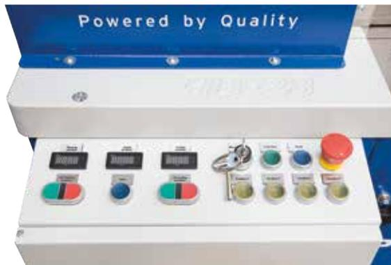
**Übersichtliches Bedienpanel** für Betriebsmodus Manuell und Automatik und Speicher für 4 verschiedene Programme
