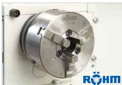
Hochwertiges RÖHM Dreibacken-Drehfutter aus Stahl
