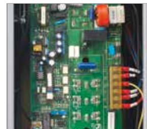
Moderne, kompakte Steuerungselektronik für Super-Vario-Speed
