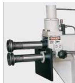
Hydraulisch einstellbare Mitlaufwalze für Blechdicken ab 2 mm (Sonderzubehör)
