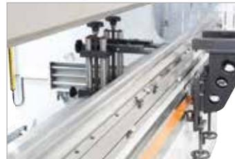
Rasch verstellbare Auflagearme mit Lineal und T-Nut
