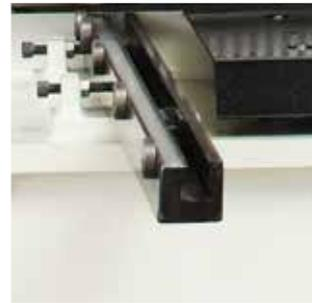
Gute Führung - Auflagearm mit Lineal und Anschlag
