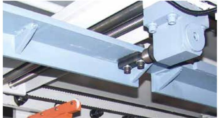
NC-gesteuertes Hinteranschlagsystem für automatische Positionierung und Rückstellung über Kugelumlaufspindel
