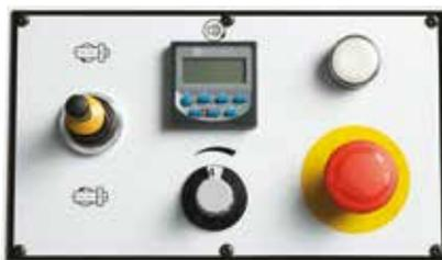
Mitfahrendes Steuerpult mit Drehspindel R/L-Steuereinheit, digitaler Drehzahlanzeige, Vario-Speed-Drehzahlregelung, Betriebslampe und Not-Aus-Taster
