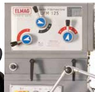
UFM 125 Spindelgetriebe mit Schnellschaltelementen
