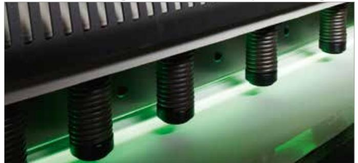
Automatisches Niederhaltersystem und Schnittlinienbeleuchtung
