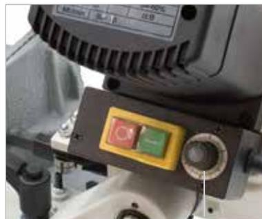
Stufenlos einstellbare Schnittgeschwindigkeit mit Drehregler SGR
