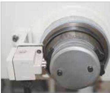
Gewindeschneideinrichtung mit Drehrichtungsumkehr ab KSBM 5/63:
