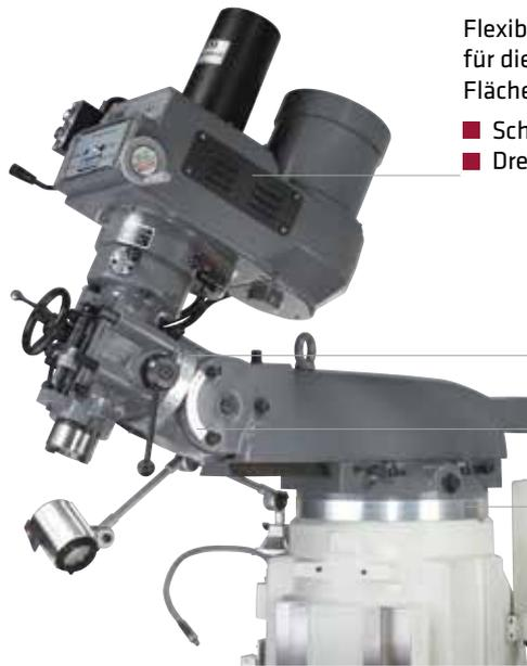
Flexibel einstellbarer Fräskopf für die Bearbeitung schräger Flächen und große Werkstücke:
