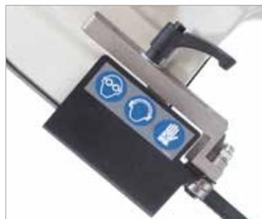
Lösen und Verstellen der Spannager mit einer Hebeldehnung
