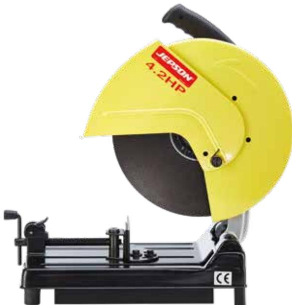
Rasch einstellbares Schnellspannsystem 0-45° mit großem Spannbereich
