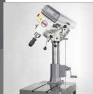
Ausleger stufenlos ± 90° schwenkbar
