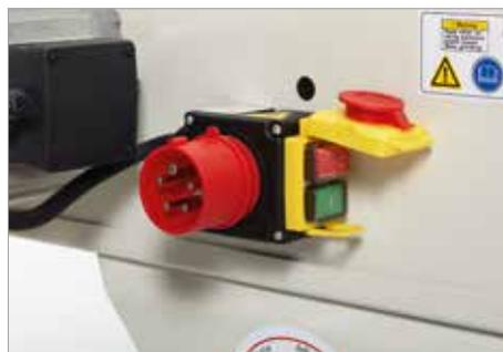
Netzteil mit versperbarem Ein-/Aus, Not-Aus und CEE-Schutzstecker 400 V
