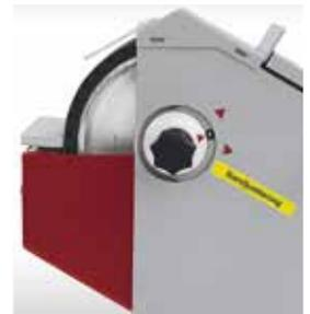
BandlaufEinstellung mit präziser Bandjustierung
