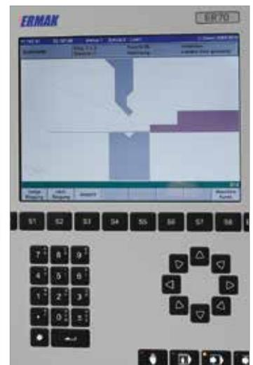
Produktzeichnung, Biegesimulation und Kollisionsprüfung in 2D
