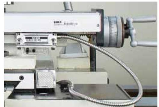
Oberschlitten mit Ableseeinheit auf einer Universal Drehmaschine
