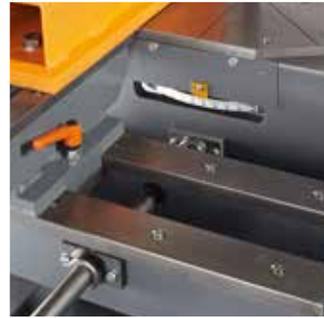
Winkelschnellspanner mit großer, präziser Skala
