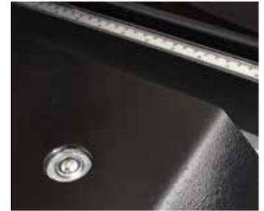
Auflagetisch mit Kugelrollen für mühelose Blechpositionierung
