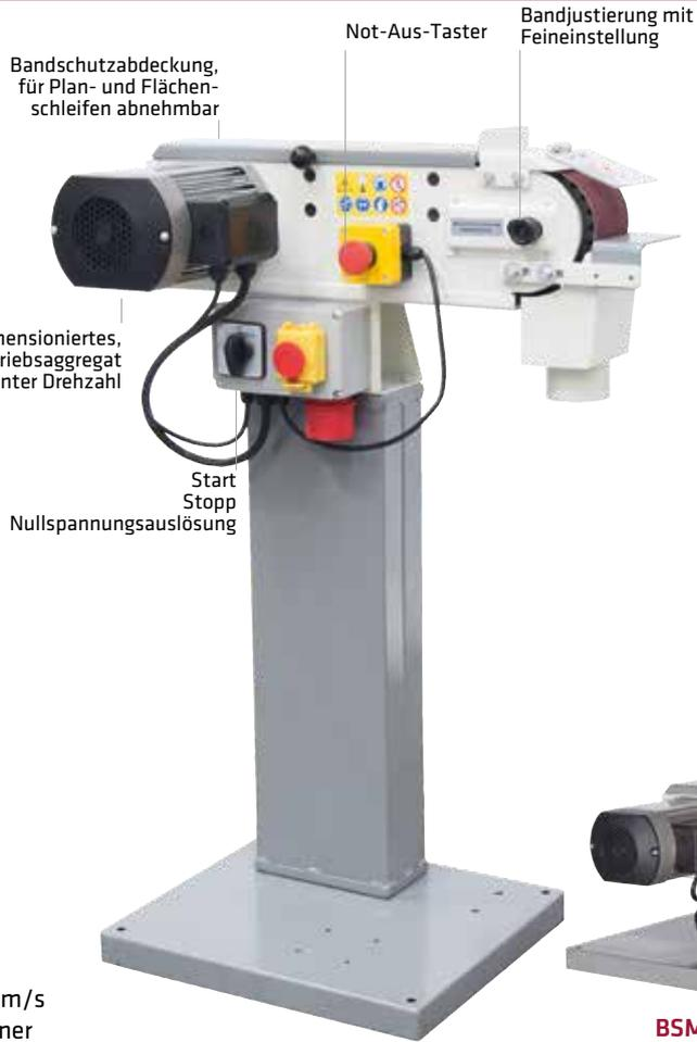
Bandschutzabdeckung, für Plan- und Flächenschleifen abnehmbar
