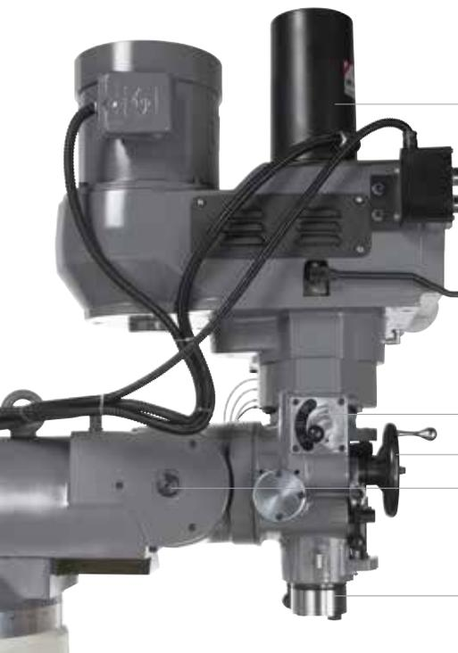
Mechanische Spindelbremse für rasches Abbremsen der Frässpindel
