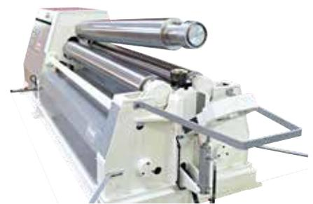
Das Ausklinken der Oberwalze erfolgt hydraulisch.
