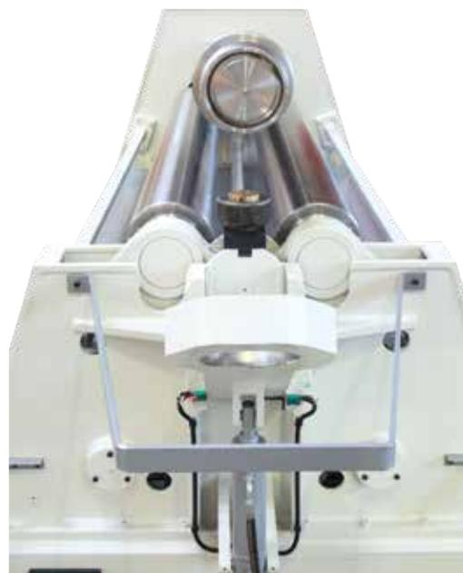
Hydraulisch betätigtes Gegenlager
