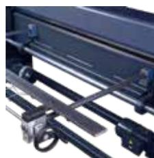
Manueller Hinteranschlag mit Zähler
