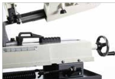
Schnellspannschraubstock mit Distanzhalter und Einstellskala
