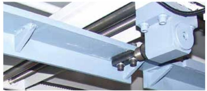
NC-gesteuertes Hinteranschlagsystem für automatische Positionierung und Rückstellung über Kugelumlaufspindel
