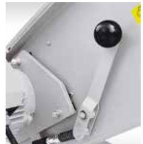
Schnellspannhebel für Schleifbandspannung
