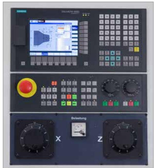
Steuerpanel mit 2 elektronischen Handrädern
