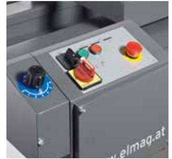
Absenkautomatik - Drehregler am Steuerpult
