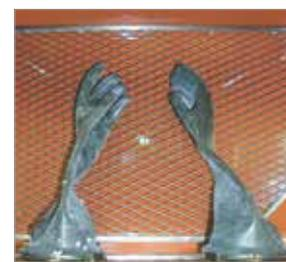
Integrierte Schutzhandschuhe aus flexiblem Kunststoff
