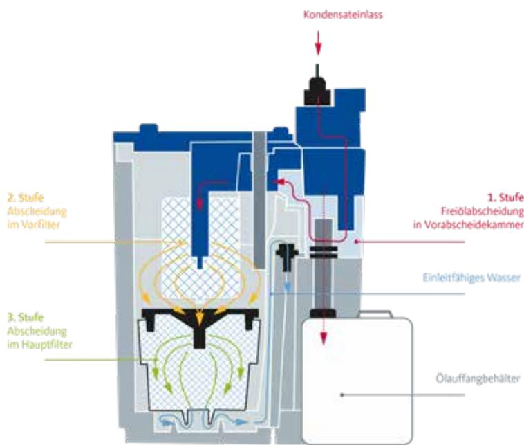
Für die Aufbereitung gelangt das ölhaltige Kondensat zunächst unter Druck in die Druckenlastungskammer. Dort wird der Überdruck abgebaut, ohne dass es zu Verwirbelungen im nachfolgenden Trennbehälter zur Freilölabscheidung **(1)** kommt. Mitgeführte grobe Schmutzpartikel werden in einem herausnehmbaren Auffang zurückgehalten. Im Trennbehälter setzt sich das Öl durch Schwerkrafttrennung an der Oberfläche ab und wird in den überlaufsicheren Ölaufangbehälter geleitet.
