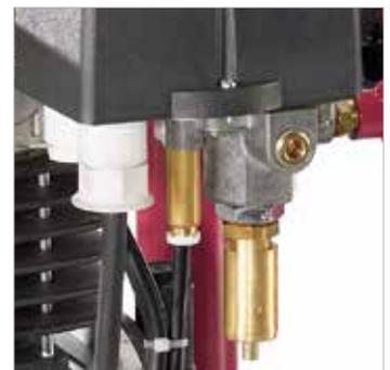
Sicherheitsventil und Druckentlastungsventil
