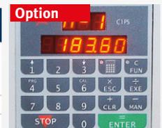
**Option PFS 520:** Elektronische Dickentischpositionierung über Tastatur mit Inkremental- und Taschenrechnerfunktion
