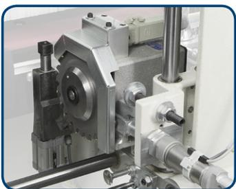
► **Bündig-Kappaggregat mit Säge und Funktion Eckenrunden**
