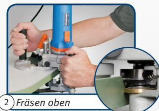
· Doppelseitiges Fräsen in zwei Arbeitsschritten ohne das Werkstück umdrehen zu müssen (Vorteil bei Reparaturen von fertigen Möbelteilen)
