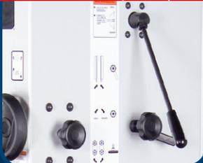
· Sägebandschnellspannung über Exzenterhebel auf der Maschinenrückseite
