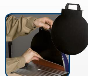
**Trennblech zum Schleifscheibenwechsel**
