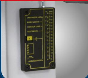
Im Maschinenrahmen integrierte Anzeige der Sägebandspannung für verschiedene Bandbreiten
