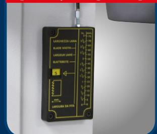
Am Maschinenrahmen integrierte Anzeige der Sägebandspannung für verschiedene Bandbreiten
