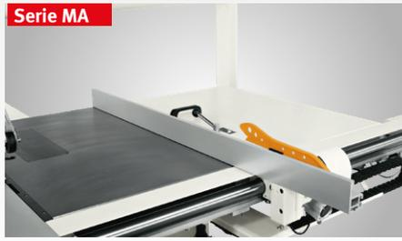
**Motorisierter Parallelanschlag mit elektronischer Positionierung**
