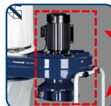
Bei den Modellen ASA 2401, ASA 2403, ASA 3303, ASA 4003 und ASA 5403 kann die Ansaugeneinheit um 180° gedreht verbaut werden, wodurch die Ansaugrichtung von oben oder unten ermöglicht wird
