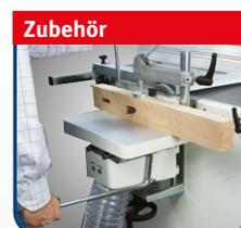
Option Langlochbohrereinrichtung mit Wescott-Bohrfutter 0-16 mm
