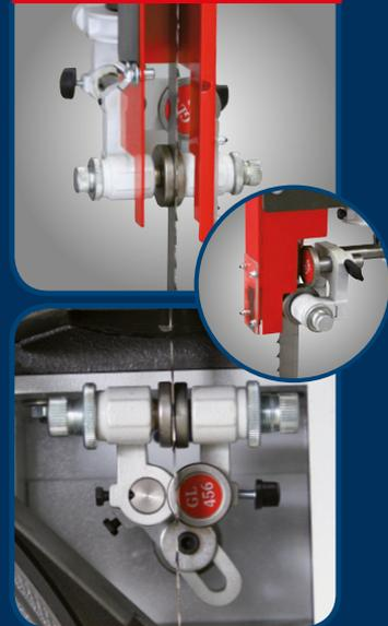
Präzisions-3-Rollen-Sägebandführung mit Führungsrollen oben und unten und Feineinstellung
