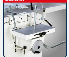
Langlochbohrereinrichtung in Guss-Ausführung
