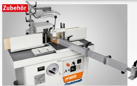
► Zubehör Schiebeshlitten für kleine Zapfenschneidbearbeitungen und zum Schlitzzen
