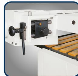
Die Bandschnellspannung ermöglicht schnelles und problemloses Wechseln der Schleifbänder.
